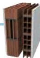
Lastre Aquapanel Outdoor su orditura metallica C Plus 27/50/27, interasse 400 mm, acciaio Aluzink sp. 8/10 mm
